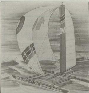
La mise au point de «MONTPELLIER LANGUEDOC-ROUSSILLON» a nécessité huit mois d'études. Il mesurera 20 mètres sur 20, pèsera 4 tonnes, aura une voileure de 190 m<sup>2</sup> et pourra atteindre la vitesse de 35 noeuds. Il sera composé de deux bras non articulés et d'un flotteur long. Un nouveau grément à balestron a été mis au point de même qu'un système de foils à incidence proportionnelle à la vitesse. Coût total : de 2 à 3 millions de francs.
