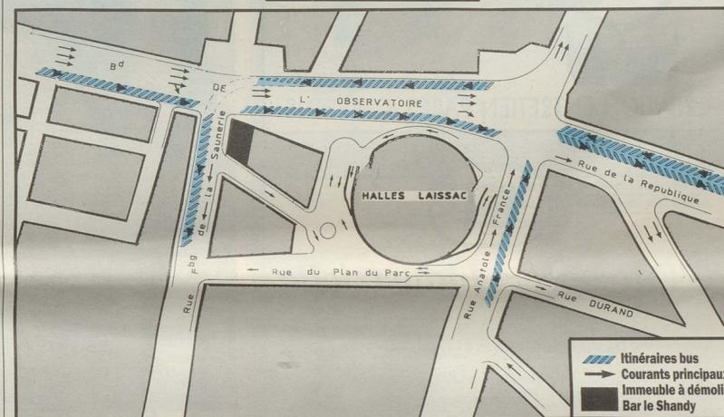
La solution consiste à démolir l'angle Saunerie/Observatoire pour réaliser la cinquième voie sur l'emprise actuelle de l'immeuble abritant le bar "Le Shandy". L'opération réalisée, les deux couloirs de bus seront accolés pour bénéficier d'un quai commun de chargement et de déchargement. Les véhicules, quant à eux, circuleront sur la partie gauche, côté centre historique, en direction du tunnel de la Comédie ou des rues de la République et d'Alger.
