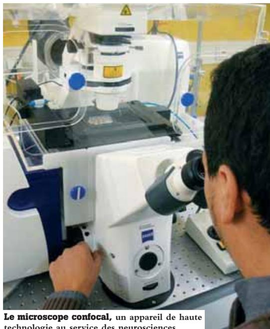
Le microscope confocal, un appareil de haute technologie au service des neurosciences.
