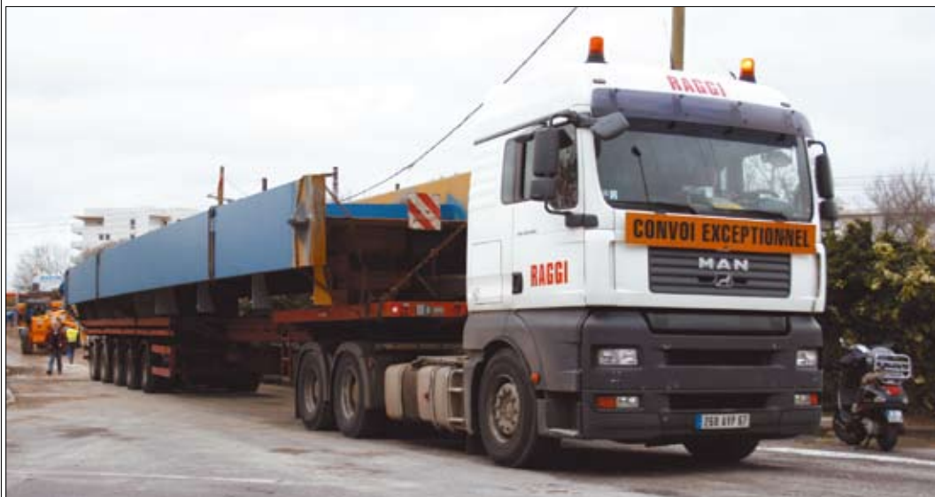
L'ossature métallique du tablier du futur pont du Mas du Rochet est arrivée par convoi exceptionnel des usines Richard Ducros dans les Vosges, le 5 février dernier.
