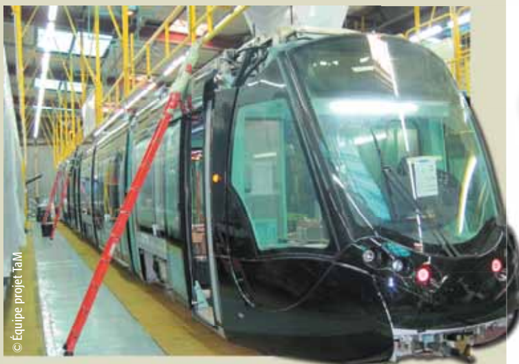
Des essais statiques de la première rame sont en cours sur le site d'Alstom. D'ici un an, 19 rames identiques sortiront du centre de fabrication des tramways à Aytré près de la Rochelle.
