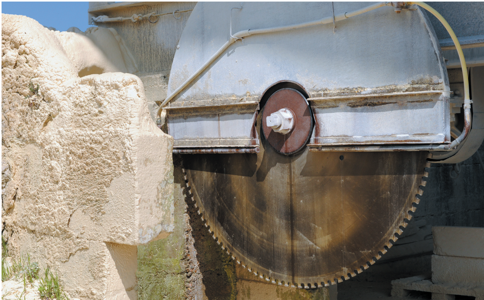
Une scie circulaire débite avec précision les blocs à la demande des clients.
