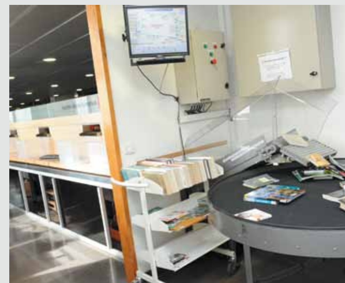
Près de la zone de retour de prêt, les ouvrages défilent sur un tapis roulant qui permet aux agents de la médiathèque de les classer selon la section à laquelle ils appartiennent.
