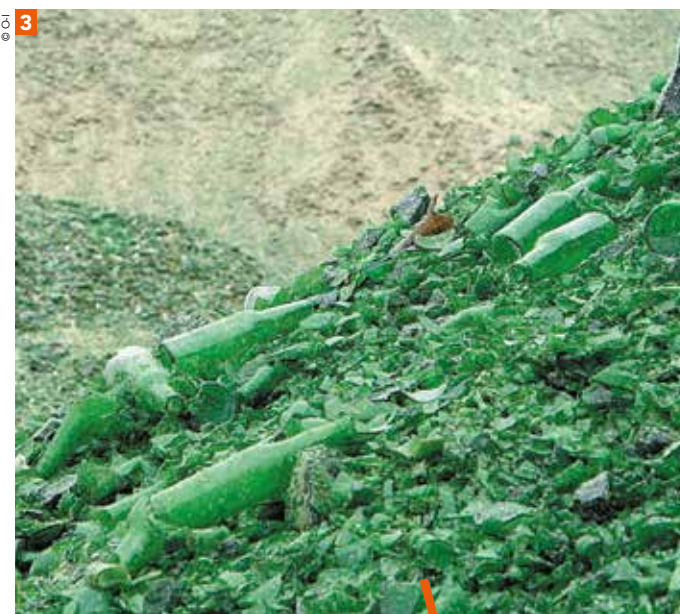
Débarrassé des impuretés, le verre est stocké en attendant de passer au four. Une tonne de ce verre donnera une tonne de verre recyclé.
