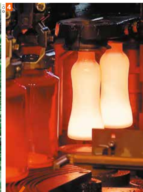
Le verre est fondu dans un four à 1500°C. Pour que la couleur du verre recyclé soit stable, et ne varie pas en fonction de celle des verres collectés, il est nécessaire d'ajouter 10% de matières premières pour 90% de verre recyclé. À partir de ce verre fondu, de nouvelles bouteilles sont formées.
