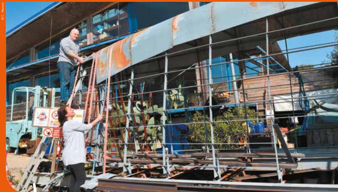
La première coque du catamaran commence à prendre forme. Après la finalisation du fond de coque, les membres de l'association s'attaqueront aux flancs.
