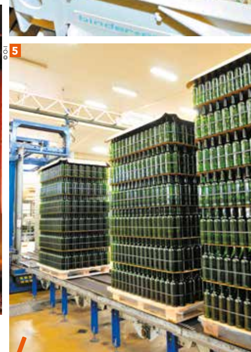
Refroidie, la bouteille de verre prend sa couleur définitive : verte, transparente ou marron le plus souvent. Elle est conditionnée et prête à être vendue aux fabricants d'eau minérale, de vins, de bière, de jus de fruits...
